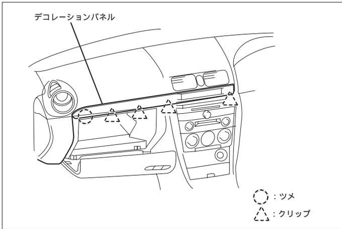
(1) デコレーションパネルを取外します。(右側より取外します)
