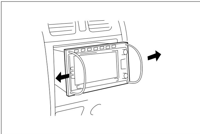
(2) 専用取付治具を使用してオーディオA'ssyを取外します。
