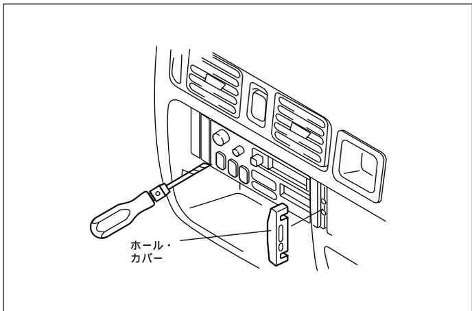
(2)取外し専用治具を使用して、オーディオA ssyを取外します。
