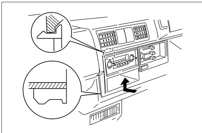
(1)ラジオパネルの取外しは、ラジオのノブを外してから行います。
