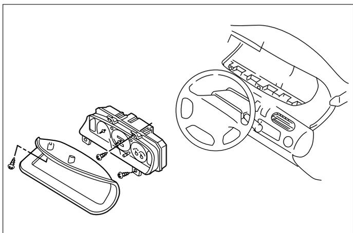
(1) メーターフードの取付けスクリューを外し、メーターフードを取外します。
