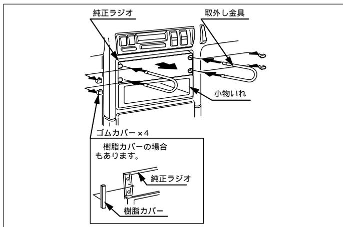
(1)オーディオ・ユニットのサービスホールに取外し専用治具を差し込み、治具を外側に広げる様にしてオーディオ・ユニットを取外します。
