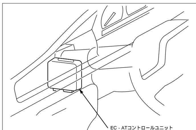
(1)ステアリングコラム左下の奥側に EC-ATコントロールユニットが取り付けられています。
