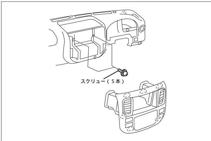
(2) センターベンチレーターグリルとクラスターリッドCの隙間に手を掛け、まっすぐ手前に引いて取外します。
