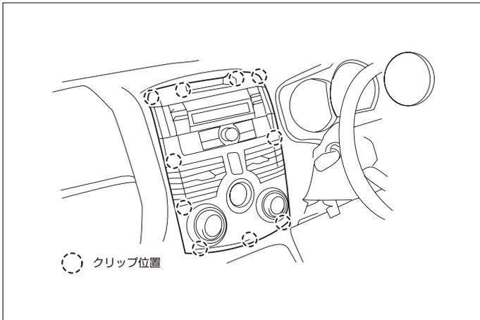
(1) インstrumentクラスターセンターパネルを取外します。
