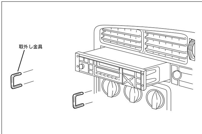
(1) 純正オーディオのホールに取外し金具を差し込み、取外します。
