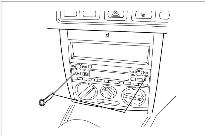
(1) 専用取外し治具を使用して、オーディオを取外します。
