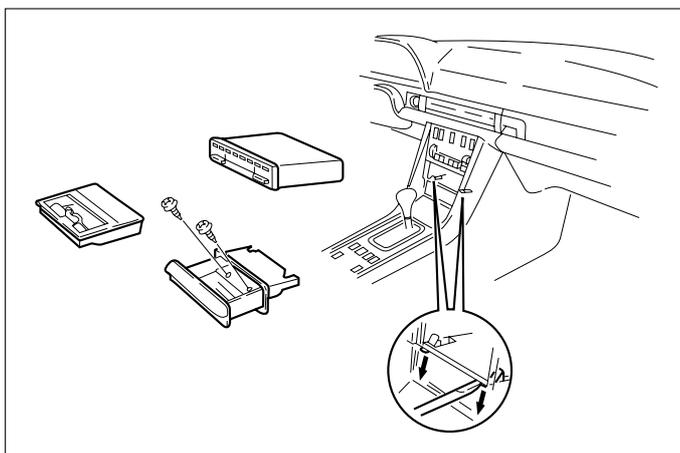
(1)灰皿を手前に引き、受皿を外し、灰皿を外します。
