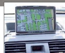
● 空港面監視システム 車載モニター
