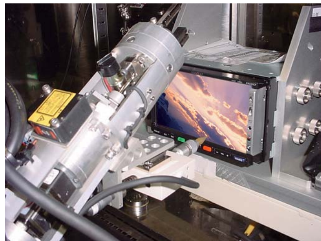
自動評価システム 操作ロボットと画像認識を 組合せ自動的に機能の評価
