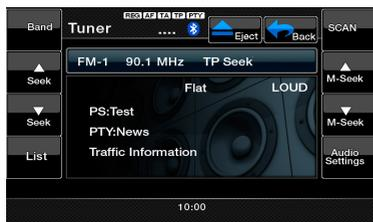
Toque la tecla **[Band]** (Banda) o el botón **[Band]** (Banda) del mando a distancia para seleccionar la banda de radio. Cada vez que se pulsa el botón, la banda de recepción de radio cambia en el orden siguiente: FM1, FM2, FM3, AM, FM1...
